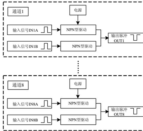
图 2 电原理框图
